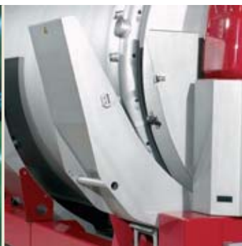
Lavado por tubo-colector de mosto liberado para Bucher XPert 250 / 320 / 450
