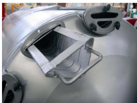
Extracción de las canaletas agujereadas
