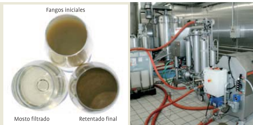
Ejemplo de instalación de filtración para fangos.
