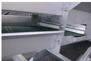
Rasqueta de limpieza de la cara inferior de la cinta
